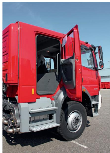
Ergonomischer Einstieg und automatisch klappbare Trittstufen
