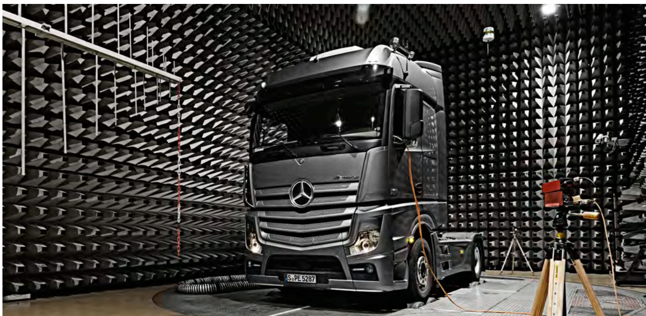
EMV-Prüfung in einer speziell vor elektromagnetischen Fremdstörungen abgeschirmten Halle.
